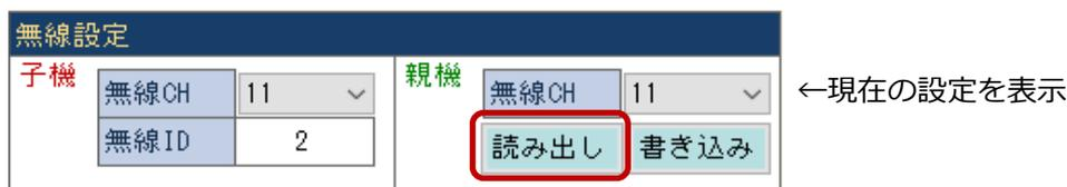
④無線CHを変更し、書き込みボタンで無線受信機に変更内容を書き込みます。成功すると完了メッセージを表示します。
